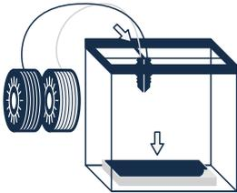
**1** Legen Sie *P-filament 721*, *P-support 279* und *P-surface 141* in Ihren 3D-Drucker ein. Verwenden Sie für *P-support 279* die **3D-Druckparameter** von löslichen Stützmaterialien, d. h. verwenden Sie keinen vertikalen Versatz zwischen dem Stützmaterial und der PP-Schicht. Weiterhin eignet sich *P-support 279* hervorragend zum Drucken eines Floßes.
