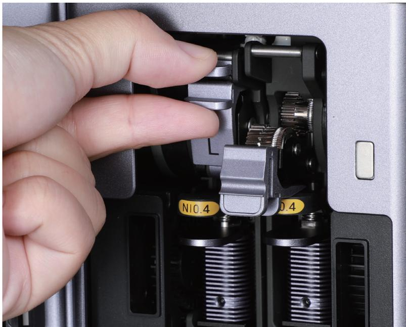
4. Reinigen Sie die Filamentspäne von den Extruderzahnädern mit der weichen Bürste.
