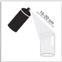
Das gleichmäßige Aufsprühen von AESUB white wird mit einem Abstand zwischen 15-20 cm zum Messobjekt empfohlen. Dabei sollte die Aerosoldose in gleichmäßigen und langsamen Hin- und Herbewegungen über den zu scannenden Bereich geführt werden, ohne dabei länger an einer Stelle zu verweilen.
