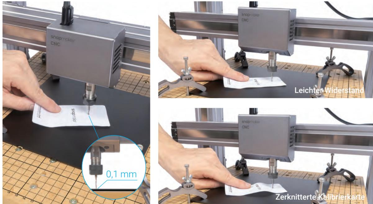
4. Tippen Sie auf **Z+**, um den CNC-Fräser anzuheben, bis er sich über dem Klemmsset befindet, und tippen Sie dann auf **Ausführungsgrenze**, um zu prüfen, ob der Arbeitsursprung korrekt ist. Wenn ein Teil der vom CNC-Fräser gezogenen Begrenzung außerhalb des Materials liegt oder wenn der CNC-Fräser auf Teile des Gerätes stößt, setzen Sie den Arbeitsursprung zurück und führen Sie die Begrenzung erneut aus.
