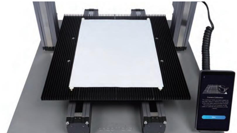
2. Tippen Sie auf **Start**, und das Gerät wird das eingravierte Quadrat zur Kalibrierung der Kamera verwenden.
