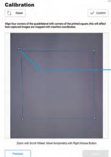
Klicken Sie auf **Bestätigen** und das fertige Bild wird in den Quadranten im Koordinatensystem geladen. Wiederholen Sie die obigen Schritte, wenn die Ränder des aufgenommenen Bildes immer noch nicht ausgerichtet sind.
