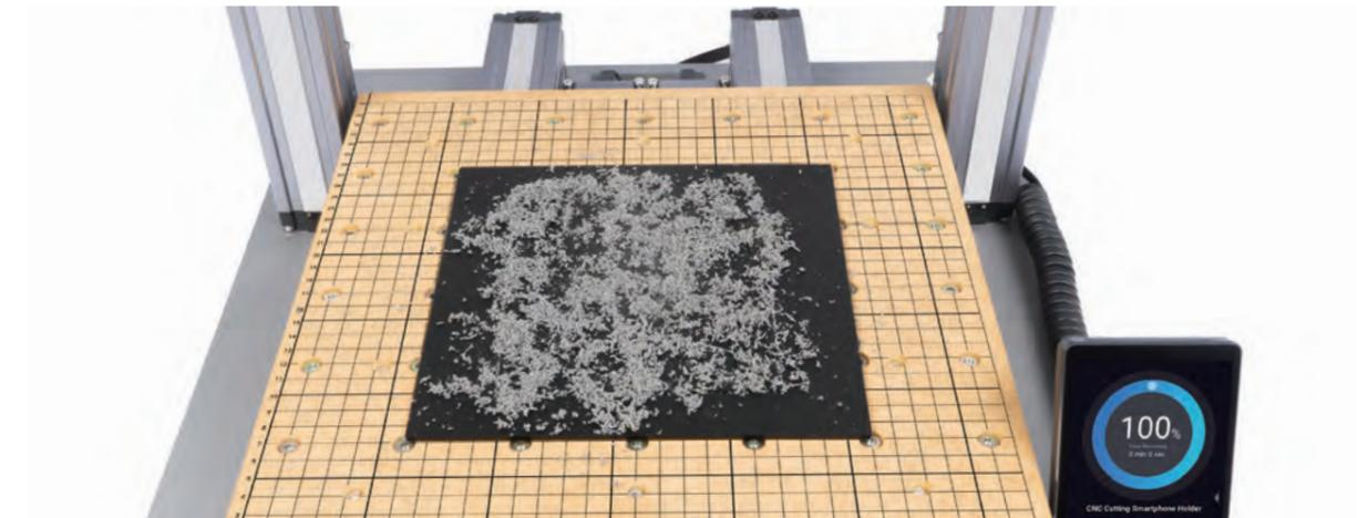
2. Reinigen Sie das fertige Werkstück und das Gerät mit einem Staubsauger und entfernen Sie dann das fertige Werkstück mit dem Seitenschneider.
