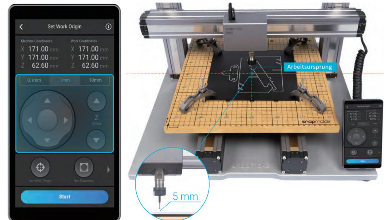
3. Legen Sie die Kalibrierkarte oder ein Stück A4-Papier zwischen den CNC-Fräser und das Material. Stellen Sie die Höhe des CNC-Fräasers mit Hilfe der Tasten **Z-** oder **Z+** so lange ein, bis Sie beim Herausziehen der Kalibrierkarte einen leichten Widerstand spüren und sie beim Vorwärtsschieben zerknittern sollte. Tippen Sie auf **Arbeitsursprung einstellen**.
