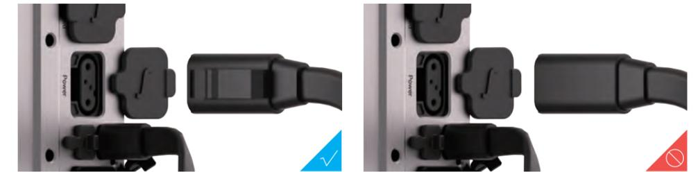
Stellen Sie sicher, dass die Anschlüsse in die richtige Richtung weisen.
