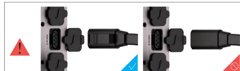
Stellen Sie sicher, dass die Anschlüsse in die richtige Richtung weisen.
