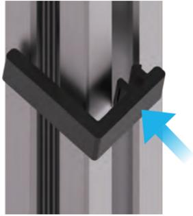
Kippen Sie die Einrastverbindung der Kabelklemme ein und drücken Sie sie gegen die Nut des Trägers, um sie einzurasten. Die Leiste der Kabelklemme sollte das Kabel in der angrenzenden Nut halten.
