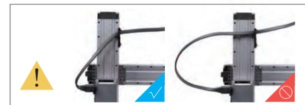
Stellen Sie sicher, dass genügend Kabellänge für die Bewegung des Werkzeugkopfes vorhanden ist.
