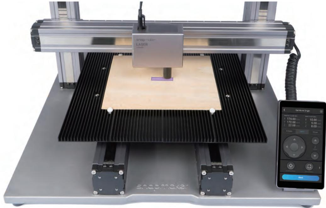
5. Tippen Sie auf **Start**, und das Gerät fokussiert automatisch.
