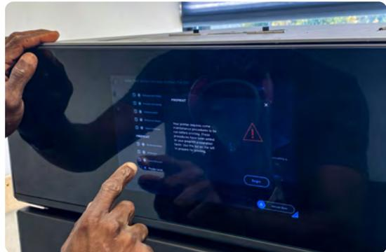
**5. Einen Druck starten:** Sobald alle Überprüfungen vor dem Drucken abgeschlossen sind, ist der Fuse 1 druckbereit. Der Startbildschirm wechselt zur Anzeige eines Live-Streams des Druckbetts, sodass Sie beobachten können, wie jede neue Schicht Gestalt annimmt. Diese Kameraansicht ist ebenso in PreForm verfügbar.
